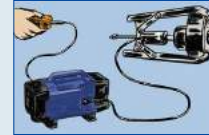
プーラーの組合せ作業 Gear, pulley removal
