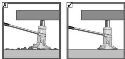
油圧ジャッキは平らで荷重を支えられる堅固な面に設置して下さい。
