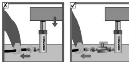
加圧状態でカプラを外さないで下さい。もし外す必要がある時は、必ずシャフトオフバルブを使用して下さい。
