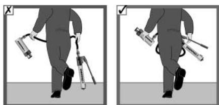
油圧機器を移動する時に油圧ホースで持ち上げないで下さい。
