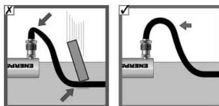
カタログに記載してあるホースの曲げ半径以下に曲げないで下さい。
