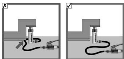
油圧ホースの取回しに注意し、損傷した場合は交換して下さい。
