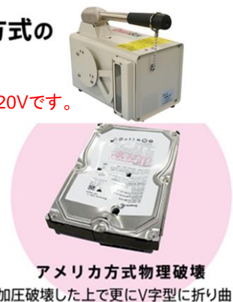
日本方式物理破壊 2箇所に穴をあけ、加圧破壊
