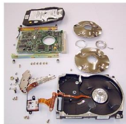
加圧変形破壊したHDD内部
