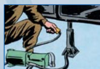
ジャッキアップ
