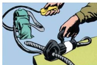
ワイヤーカッター Wire rope, cable cutting
